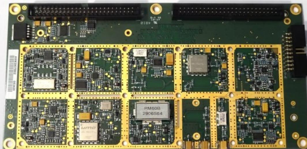
Alle Logiksignale sind mit Bustreibern (74VHCT541) gepuffert. Ein 3V-Regler(LM29415) versorgt den Empfangspfad und Teile des Sendepfads.
