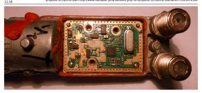
Für Horizontale und Vertikale Polarisation gibt es je ein Frontend bestehend aus einem LNA und einem Verstärker, ein Splitter teilt das verstärkte Signal auf die beiden Downconverter auf. Diese besitzen jeweils einen weiteren Verstärker pro Polarisation, dessen Spannungsversorgungen selektiv aktiviert werden. Ein Combiner wird jeweils verwendet um die beiden Verstärkerausgänge zu addieren, danach erreicht das Signal den RDA3565ES.
