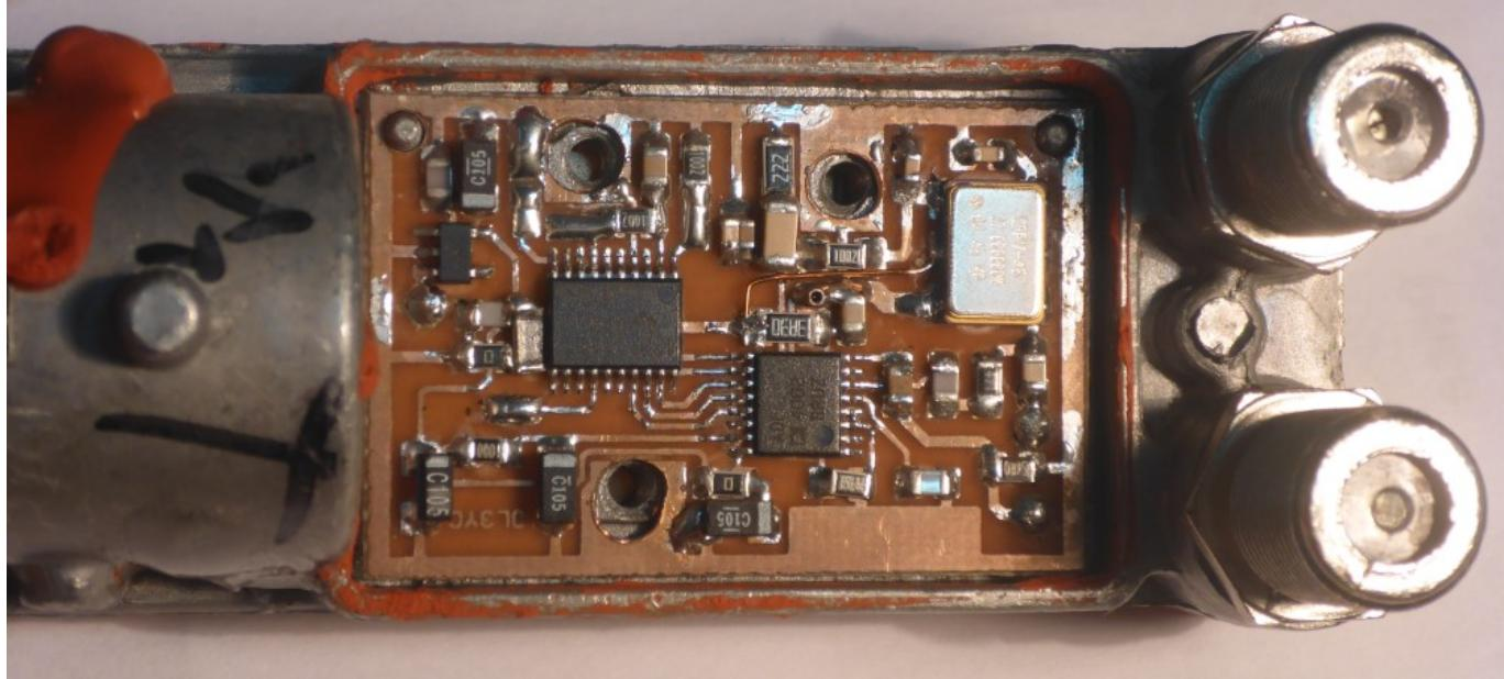
Der auf der Leiterplatte befindliche MSP430 programmiert die ADF4002-PLL und rastet damit den 27 MHz-VCXO auf die angelegte 10 MHz-Referenz. Nach erfolgreicher Inbetriebnahme ist eine Abstimmspannung von etwa 1,7 Volt am VCXO zu messen.
