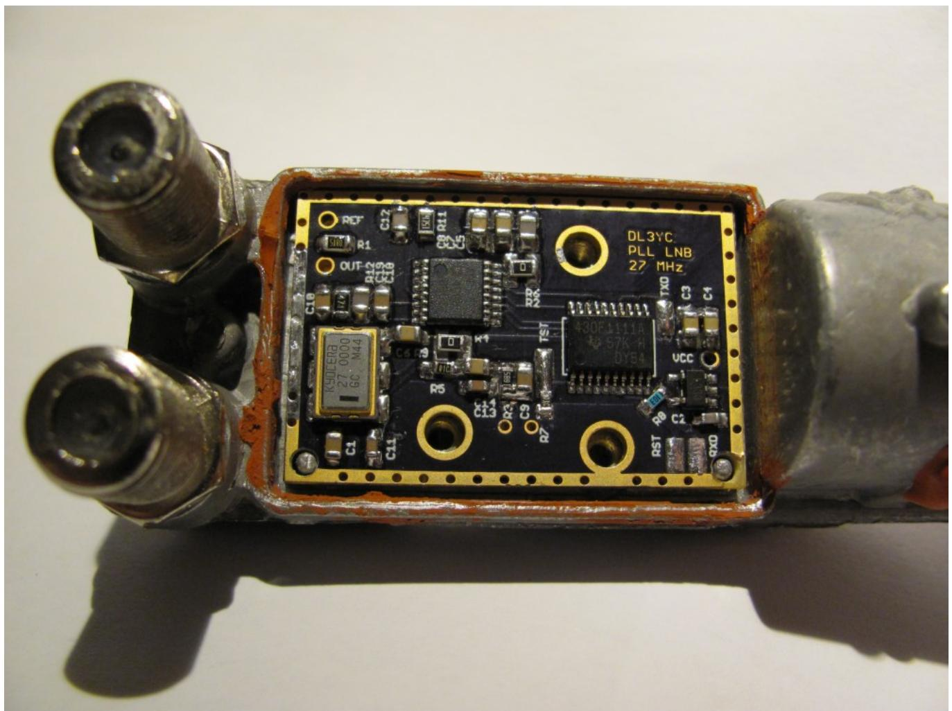
Der auf der Leiterplatte befindliche MSP430 programmiert die ADF4002-PLL und rastet damit den 27 MHz-VCXO auf die angelegte 10 MHz-Referenz. Nach erfolgreicher Inbetriebnahme ist eine Abstimmspannung von etwa 1,7 Volt am VCXO zu messen.
