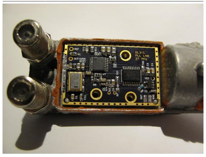
Der auf der Leiterplatte befindliche MSP430 programmiert die ADF4002-PLL und rastet damit den 27 MHz-VCXO auf die angelegte 10 MHz-Referenz. Nach erfolgreicher Inbetriebnahme ist eine Abstimmspannung von etwa 1,7 Volt am VCXO zu messen.
