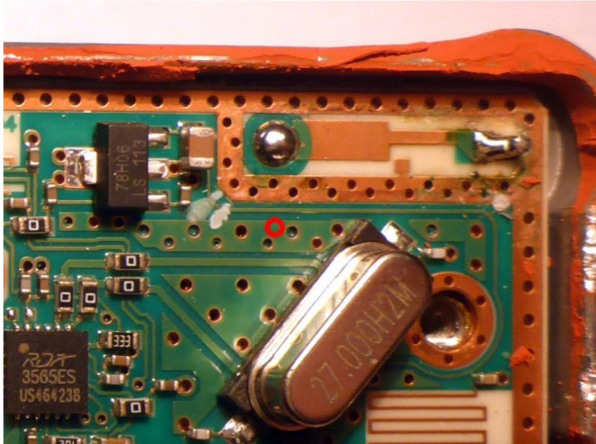
Eine der beim Ausbau gewonnenen Durchkontaktiernieten kann wiederverwendet werden und führt das 27 MHz-Signal nach oben, wo es mit einem kleinen Stück Draht an das naheliegendste Pad des ehemaligen Quarzes geführt wird. Das aufzubohrende Loch ist in der unten stehenden Grafik mit einem Pfeil markiert.
