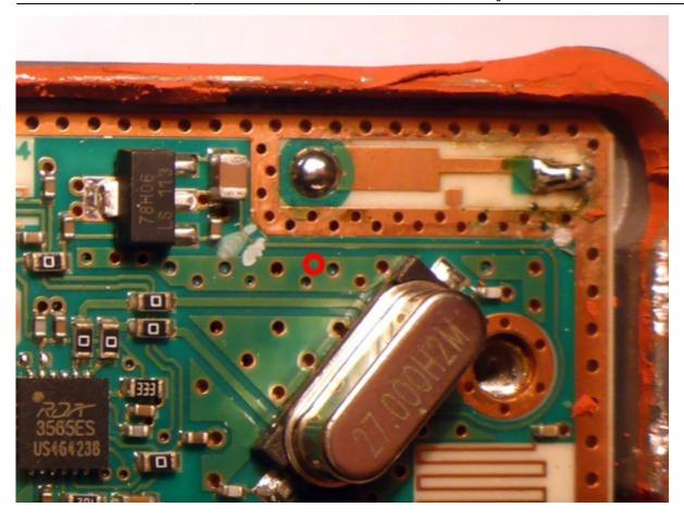
Eine der beim Ausbau gewonnenen Durchkontaktiernieten kann wiederverwendet werden und führt das 27 MHz-Signal nach oben, wo es mit einem kleinen Stück Draht an das naheliegendste Pad des ehemaligen Quarzes geführt wird. Das aufzubohrende Loch ist in der unten stehenden Grafik mit einem Pfeil markiert.
