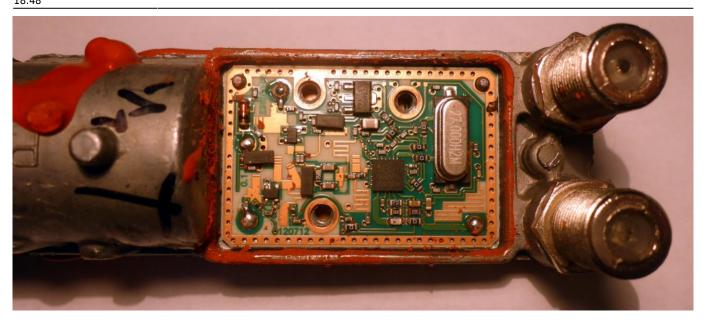
Für Horizontale und Vertikale Polarisation gibt es je ein Frontend bestehend aus einem LNA und einem Verstärker, ein Splitter teilt das verstärkte Signal auf die beiden Downconverter auf. Diese besitzen jeweils einen weiteren Verstärker pro Polarisation, dessen Spannungsversorgungen selektiv aktiviert werden. Ein Combiner wird jeweils verwendet um die beiden Verstärkerausgänge zu addieren, danach erreicht das Signal den RDA3565ES.
