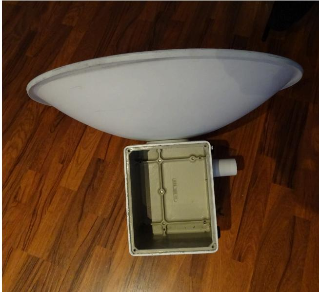
Der Durchmesser bemisst sich zu 65 cm und das Feedsystem ist auf WR90-Basis gebaut. Die direkt am Spiegel montierte witterfeste Box bietet genügend Platz für den gesamten Transverter.
