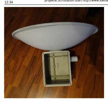
Der Durchmesser bemisst sich zu 65 cm und das Feedsystem ist auf WR90-Basis gebaut. Die direkt am Spiegel montierte wetterfeste Box bietet genügend Platz für den gesamten Transverter.
