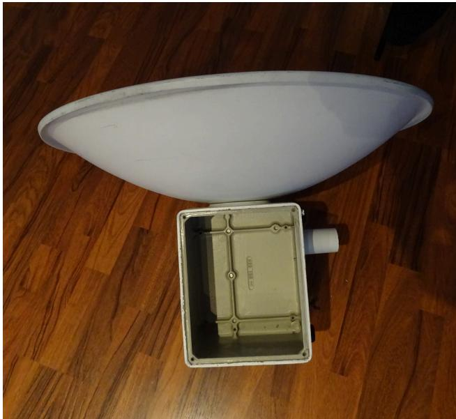
Der Durchmesser bemisst sich zu 65 cm und das Feedsystem ist auf WR90-Basis gebaut. Die direkt am Spiegel montierte wetterfeste Box bietet genügend Platz für den gesamten Transverter.
