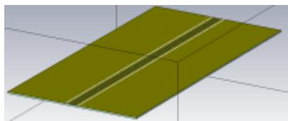
Die Vias wurden über ein Makro (vias along curve) erzeugt. Eine einfache Linie, parallel zur Leiterbahn stellte die Grundlinie bereit, entlang welcher 20 Vias auf der Leiterplatte erzeugt wurden. Leider arbeitet es nicht schön dynamisch mit den Parametern, sondern legt selbst hardcoded Parameter ab, wodurch das Makro bei jeder Geometrieänderung neu aufgerufen werden muss.
