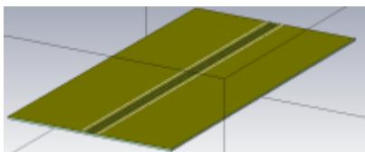
Die Vias wurden über ein Makro (vias along curve) erzeugt. Eine einfache Linie, parallel zur Leiterbahn stellte die Grundlinie bereit, entlang welcher 20 Vias auf der Leiterplatte erzeugt wurden. Leider arbeitet es nicht schön dynamisch mit den Parametern, sondern legt selbst hardcoded Parameter ab, wodurch das Makro bei jeder Geometrieveränderung neu aufgerufen werden muss.
