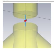
Als Lösungsmethode wurde der Transient Solver gewählt und es wurde S-Parameter S11 von 0 bis 2 GHz und das Fernfeld bei 1090 MHz simuliert.
