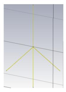
Die Radials wurden im Entwurfsprozess mit einem, alle Radials schneidenden, Zylinder verbunden und die 4 Körper zu einem verbunden. Die Geometrie ist vollständig parametrisierbar, die Antenne kann also z.B. vom Optimizer auf eine bestimmte Resonanzfrequenz angepasst werden. Strahler und Radials sind durch ihre Parameter lambda/4 lang und werden mit dem Verkürzungsfaktor k versehen.
