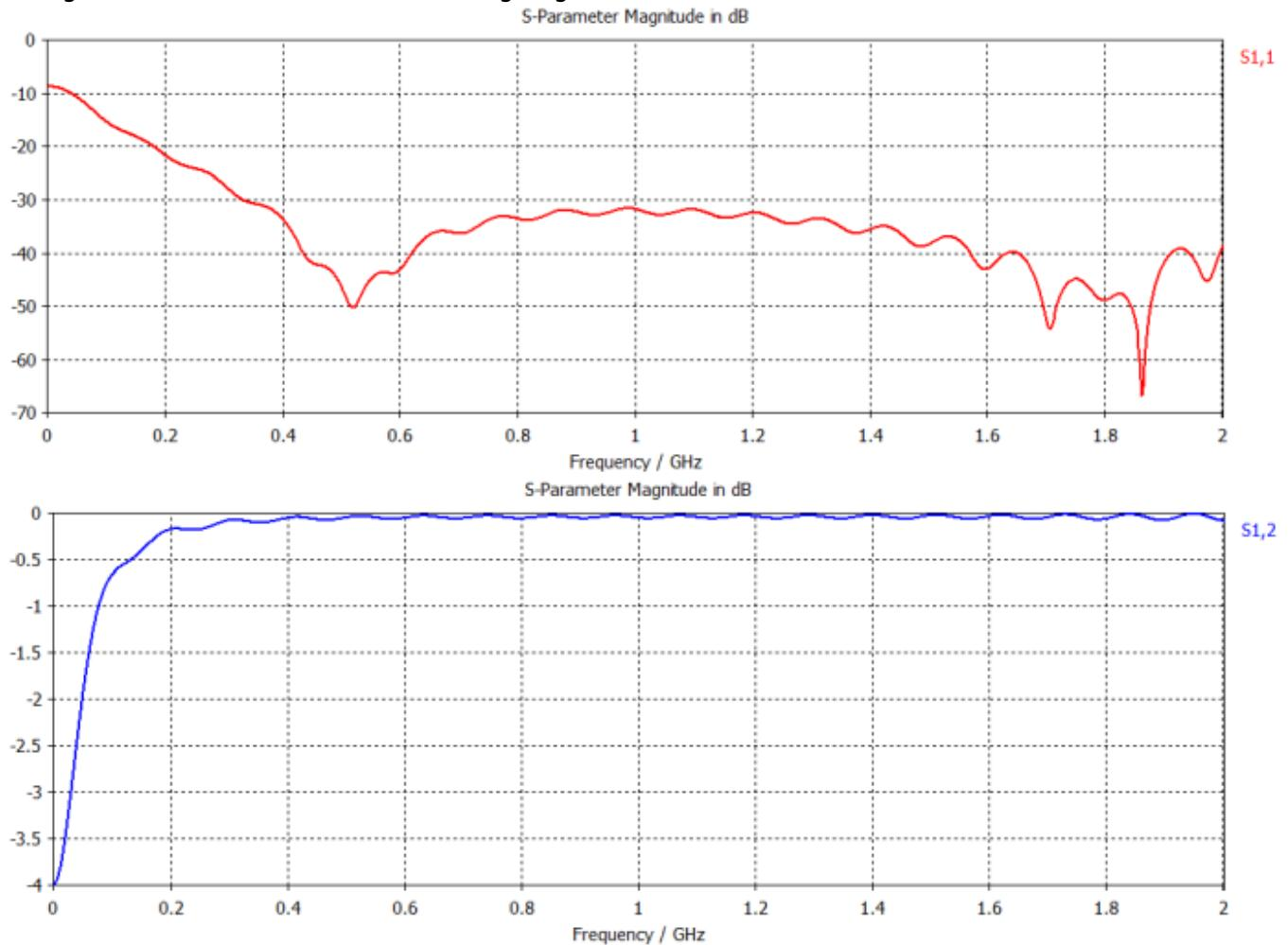
Wie zu erwarten war, ist die Dämpfung im Bereich kleiner Frequenzen sehr groß, bleibt aber dann über einen weiten Frequenzbereich bis über 2GHz sehr klein (<0.1dB). Reflexionen treten kaum auf, die Anpassung an 50 Ohm ist also durchaus gegeben. Es ließen sich durch Verändern der Geometrie schnell deutlich schlechtere Ergebnisse erzielen.
