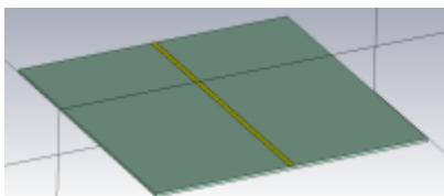
Die Geometriedefinition erfolgte wieder parametrierbar, die Maße für die Leiterbahn auf der Oberfläche wurde aus den gegebenen Werten (Kupferschichtdicke, Substratdicke, rel. Permittivität von FR-4) mit AppCAD ermittelt.
