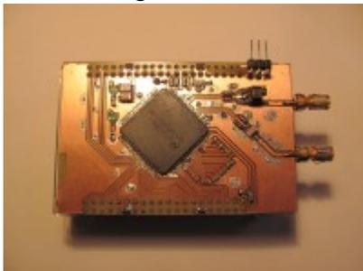
Rechts sind die Koax-Buchsen für den Antennenanschluss und den Takteingang zu sehen. Eine 3er Pinleiste ist für S/PDIF vorgesehen.
