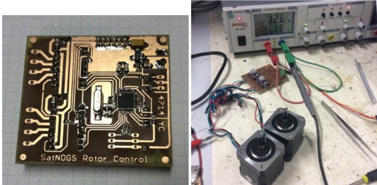
Die original SatNOGS-Elektronik verwendet einen Arduino Micro und Schrittmotortreiber von Polulu (Breakout-Board für A4988). Die Arduino-Software geht auch auf einem Standard-AtMega, als Ersatz für das Breakoutboard werden Boards mit DRV8825 benutzt.
