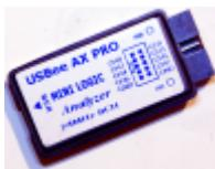
wurden drei USBee AX PRO clone von [DX](#) geordert. (zu ca. 10 € pro Stück) Dieser soll mit der Software von [USBee](#) zusammen arbeiten, da die aber nicht unter Linux läuft und auch sigrok den so nicht akzeptieren möchte, wurde der Inhalt der eeproms angepasst.
