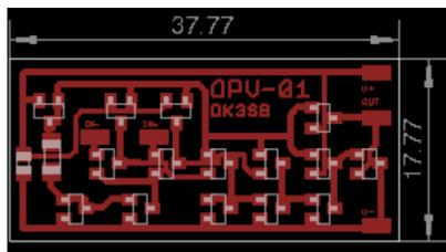
Eine Folded-Cascode-Stufe wurde aufgebaut. Die Realisierung erfolgt mit einfachen Bipolartransistoren (NPN: BC817, PNP: BC807) Arbeitswiderstände wurden als Stromquellen realisiert. Die Ausgangsstufe ist einfach aufgebaut: Eine Emitterstufe mit hoher Spannungsverstärkung aber hohem Ausgangswiderstand, gefolgt von einem Emitterfolger als Spannungsfolger mit niedrigem Ausgangswiderstand.
