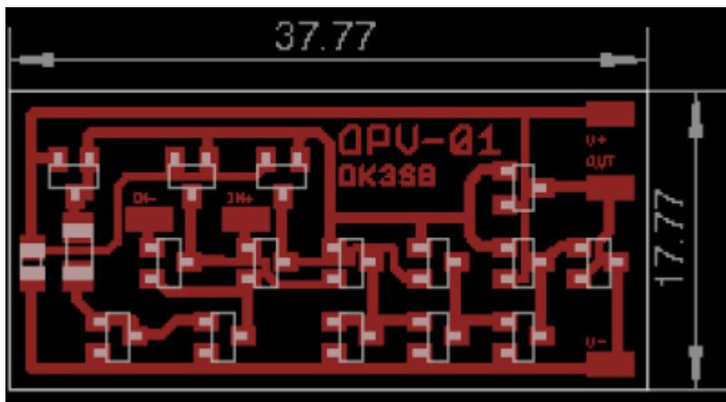
Eine Folded-Cascode-Stufe wurde aufgebaut. Die Realisierung erfolgt mit einfachen Bipolartransistoren (NPN: BC817, PNP: BC807) Arbeitswiderstände wurden als Stromquellen realisiert. Die Ausgangsstufe ist einfach aufgebaut: Eine Emitterstufe mit hoher Spannungsverstärkung aber hohem Ausgangswiderstand, gefolgt von einem Emitterfolger als Spannungsfolger mit niedrigem Ausgangswiderstand.
