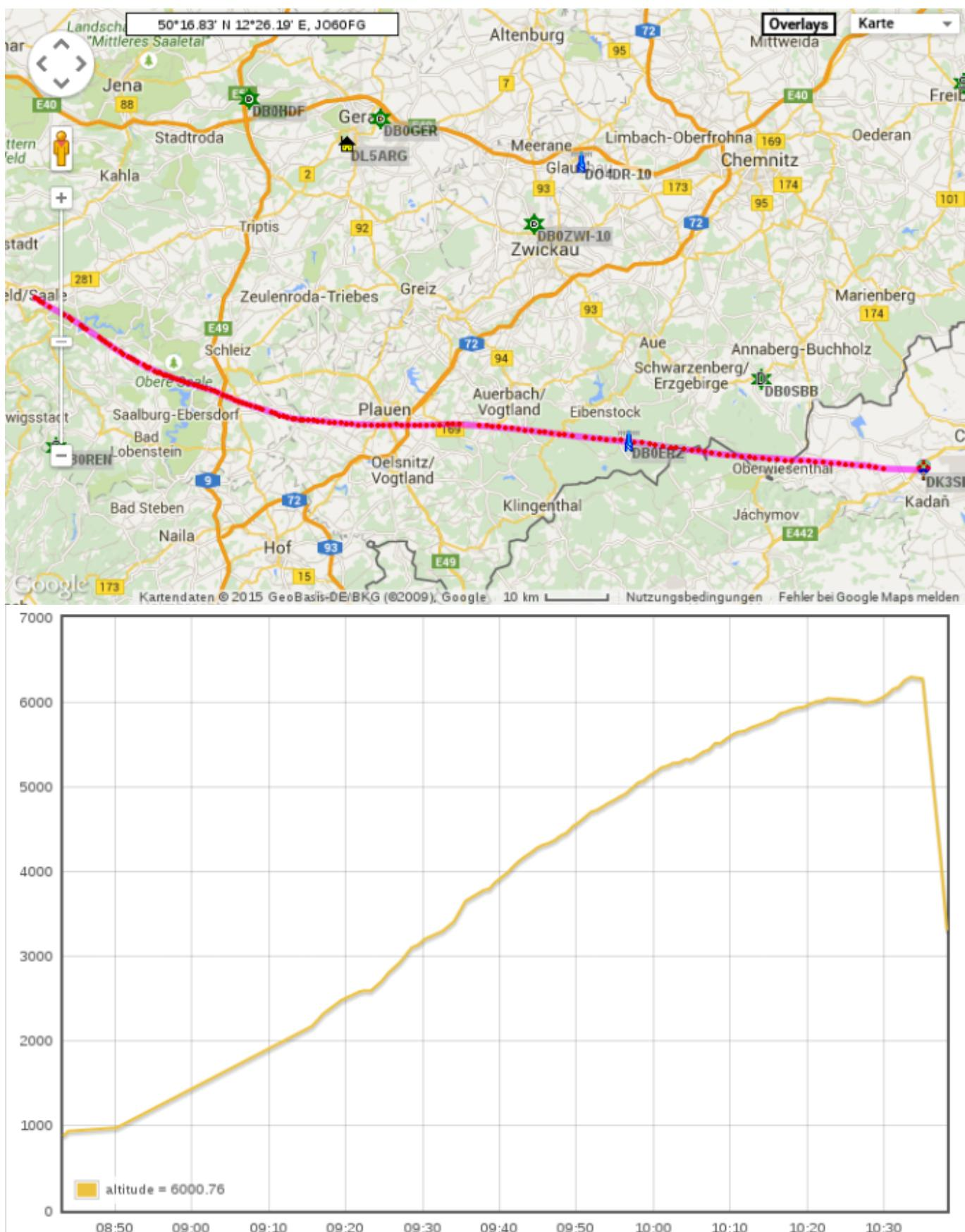
APRS als Übertragung hat sich auf jeden Fall bewährt und wurde weit aufgenommen (>180km), dies wird bei künftigen Flügen wohl als Hauptverfolgungsbetriebsart eingesetzt! Der vertikale 2m-Dipol lässt sich auch mechanisch gut realisieren.
