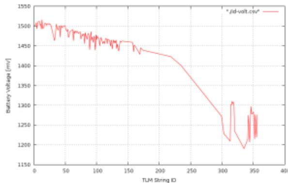
In den drei oberen Grafiken ist das Höhenprofil aus den Telemetriedaten (korrekte Zeitskala), die Temperatur-Höhe-Abhängigkeit und der Batteriespannungsverlauf zu sehen. Man sieht in letzterem die starke Temperaturabhängigkeit, die bei Alkaline-Batterien vorherrscht.
