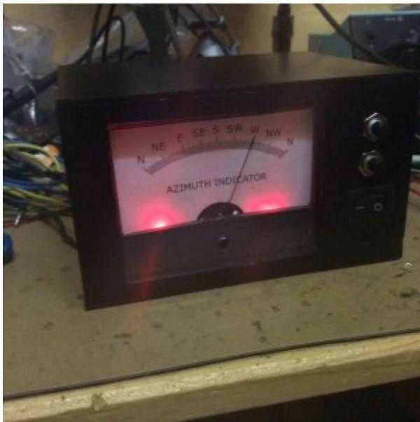
Die Elektronik beschränkt sich auf eine OPV-Schaltung, die als Impedanzwandler für das Poti und Subtrahierer einer einstellbaren Spannung wirkt. Damit kann der Offset vom 10Gang-Poti wegkalibriert werden. Die Endwertkalibrierung erfolgt über einen Serienwiderstand zum Zeigerinstrument.
