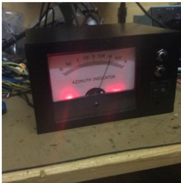
Die Elektronik beschränkt sich auf eine OPV-Schaltung, die als Impedanzwandler für das Poti und Subtrahierer einer einstellbaren Spannung wirkt. Damit kann der Offset vom 10Gang-Potentiometer-Spannungsteiler wegalibriert werden. Die Endwertkalibrierung erfolgt über einen Serienwiderstand zum Zeigerinstrument.
