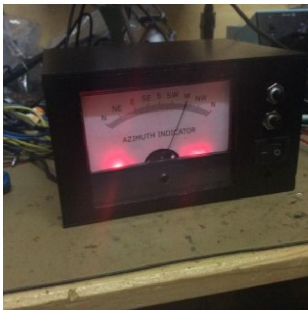
Die Elektronik beschränkt sich auf eine OPV-Schaltung, die als Impedanzwandler für das Poti und Subtrahierer einer einstellbaren Spannung wirkt. Damit kann der Offset vom 10Gang-Potentiometer-Spannungsteiler weggkalibriert werden. Die Endwertkalibrierung erfolgt über einen Serienwiderstand zum Zeigerinstrument. Ein Problem des Steuergerätes ist die Nichtlinearität des verwendeten Zeigerinstruments - ein Instrument mit Genauigkeitsklasse 1% oder besser sollte hier Verwendung finden.
