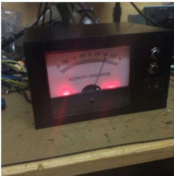
Die Elektronik beschränkt sich auf eine OPV-Schaltung, die als Impedanzwandler für das Poti und Subtrahierer einer einstellbaren Spannung wirkt. Damit kann der Offset vom 10Gang-Potentiometer-Spannungsteiler weggelöst werden. Die Endwertkalibrierung erfolgt über einen Serienwiderstand zum Zeigerinstrument. Ein Problem des Steuergerätes ist die Nichtlinearität des verwendeten Zeigerinstruments - ein Instrument mit Genauigkeitsklasse 1% oder besser sollte hier Verwendung finden.
