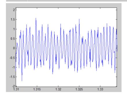
Demoduliertes Signal und Fehlersignal, 30dB SNR - am Anfang ist der Einschwingvorgang erkennbar:
