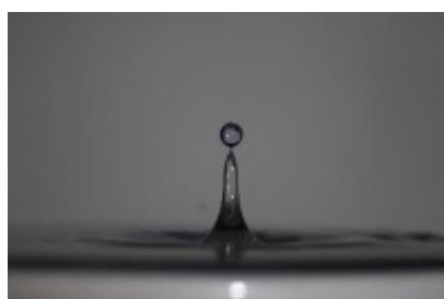
Als Zusatzaufgabe wurde das Magnetventil nach der ersten Öffnung in einem Abstand etwa 20 ms ein weiteres mal geöffnet. So lösten sich zwei Tropfen ab, deren Kollision nach dem Austreten aus der Oberfläche festgehalten werden konnten.
