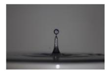
Als Zusatzaufgabe wurde das Magnetventil nach der ersten Öffnung in einem Abstand etwa 20 ms ein weiteres mal geöffnet. So lösten sich zwei Tropfen ab, deren Kollision nach dem Austreten aus der Oberfläche festgehalten werden konnten.
