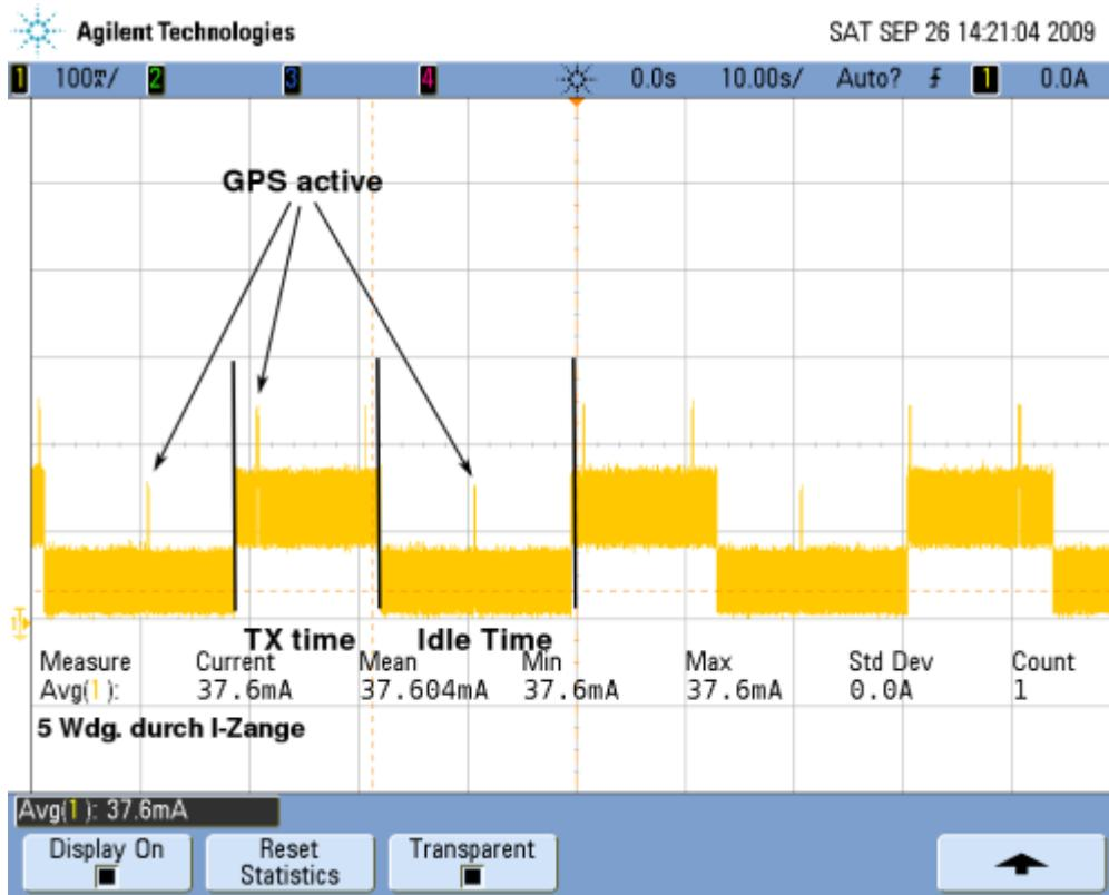
Beispielmessung mit Stromzange (nicht repräsentativ) des Stromverbrauchs. Man sieht das GPS alle 10 Sekunden aufwachen, aber noch einen rel. großen Reststromverbrauch haben (etwa 4mA), die Sendeperiode ist 30 Sekunden mit etwa 33% Duty Cycle. Gesamtstromaufnahme nach repräsentativer Messung: durchschnittlich 14mA @ 3,3V ~ 50mW
