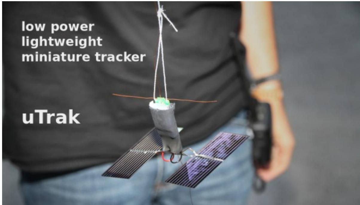
**uTrak** ist ein flexibler, auf minimale Größe und Gewicht ausgelegter Tracker für Pico-Ballonexperimente bestehend aus GPS-Empfänger, Controller auf Basis des MSP430, und Kleinleistungssender samt Antenne.
