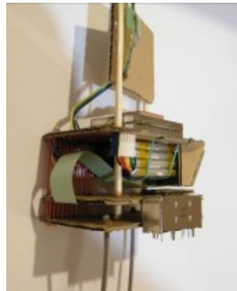
Der Abstand von Ebene 1 zum Raspberry Pi ist implizit durch die Höhe der Stiftleiste festgelegt. Die Größe der Akkus bestimmt den Abstand vom Raspberry Pi zur Ebene 3. Zwischen Ebene 1 und 2 wird der Peilsender „eingeklemmt“. Die 5V-Erzeugung für den Raspberry Pi erfolgt direkt neben dem Akku durch ein aufgeklebtes Spannungsregler-Modul.
