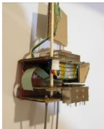
Der Abstand von Ebene 1 zum Raspberry Pi ist implizit durch die Höhe der Stiftleiste festgelegt. Die Größe der Akkus bestimmt den Abstand vom Raspberry Pi zur Ebene 3. Zwischen Ebene 2 und 3 wird der Peilsender befestigt. Die 5V-Erzeugung für den Raspberry Pi erfolgt direkt neben dem Akku durch ein aufgeklebtes Spannungsregler-Modul.
