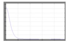
Die Beschleunigung ist erwartungsgemäß direkt nach dem Loslassen groß, geht aber sofort mit Erreichen des Kräftegleichgewichts auf 0 zurück. Da Trägheit nicht eingerechnet wurde, ist kein Unterschwingen im System zu sehen.
