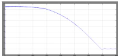
Die Geschwindigkeit erreicht bereits wenige Sekunden nach dem Start ihren Beharrungswert. Sie bleibt nahezu konstant, bis der Einfluss der dünner werdenden Luft den Auftrieb so stark reduziert, dass der Ballon irgendwann in der Luft stehen würde.
