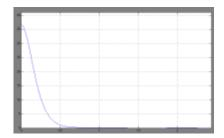
Die Beschleunigung ist erwartungsgemäß direkt nach dem Loslassen groß, geht aber sofort mit Erreichen des Kräftegleichgewichts auf 0 zurück. Da Trägheit nicht eingerechnet wurde, ist kein Unterschwingen im System zu sehen.
